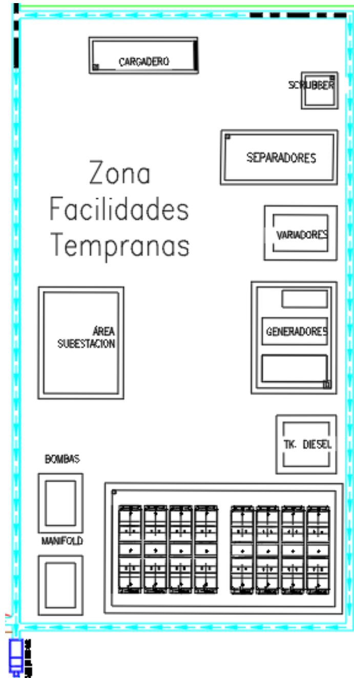
Figura 2-99 Diseño tipo de plataforma multipozo (5 ha) (200 m x 250 m) con Facilidades tempranas de producción.
