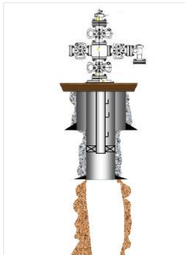
Figura 2-76 Esquema tipo de completamiento en hueco desnudo
