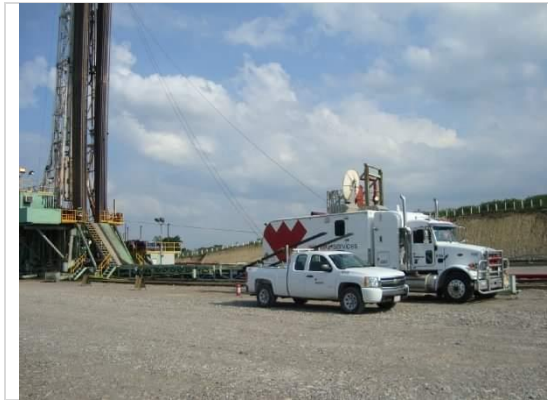
Fotografía 2-16 Unidad de Registros Eléctricos
