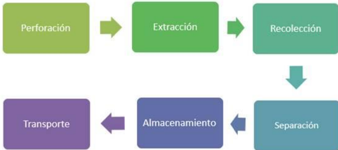
Figura 2.125 Etapas generales en la explotación de hidrocarburos
