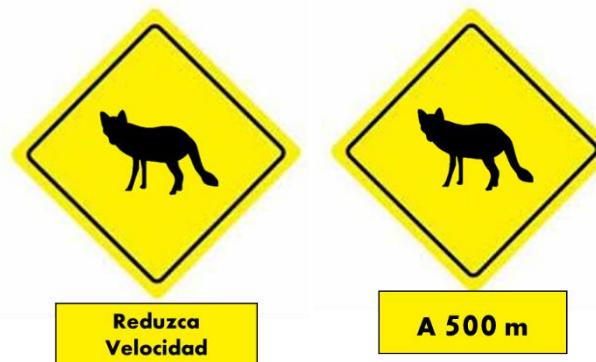
Figura 1. Diseño de señales preventivas para señalización de pasos de fauna
